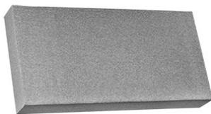
Pannello acustico anticalpestio in polistirene espanso sinterizzato additivato di grafite, Neopor® di BASF, tagliato da blocco, a bordo dritto, sottoposto a processo di elasticizzazione incrociata per aumentare le prestazioni di attenuazione dell'onda acustica (EPS T).
