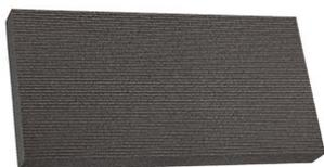
Pannello in polistirene espanso sinterizzato additivato di grafite, Neopor® di BASF, ad alta densità e basso assorbimento d'acqua, tagliato da blocco, a bordo dritto, con superficie esterna ed interna zigrinata per un migliore aggrappaggio di collanti e rasanti, idoneo per partenze di sistemi a cappotto, imbotti piani, a basso spessore (< 6 cm). Prodotto a marcatura CE e ETICS.
