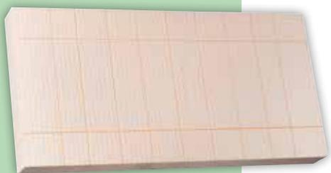
Pannello in polistirene espanso sinterizzato dotato di pellicola trasparente per resistere all'assorbimento d'acqua, stampato a bordo dritto, con superficie esterna ed interna gofrata per un migliore aggrappaggio di collanti/rasanti nei sistemi di isolamento a cappotto.
