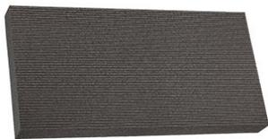
Pannello in polistirene espanso sinterizzato additivato di grafite, Neopor® di BASF, ad alta densità e basso assorbimento d'acqua, tagliato da blocco, a bordo dritto, con superficie esterna ed interna zigrinata per un migliore aggrappaggio di collanti e rasanti, idoneo per partenze di sistemi a cappotto, imbotti piani, a basso spessore (< 6 cm).
