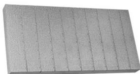
Pannello in polistirene espanso sinterizzato additivato di grafite, Neopor® di BASF, stampato a bordo dritto, con superficie esterna ed interna gofrata per un migliore aggrappaggio e pre-tagli sfalsati per garantire un'ottima stabilità dimensionale. Prodotto a marcatura CE e ETICS. Norma di riferimento UNI EN 13163:2009 e UNI EN 13499:2005.
