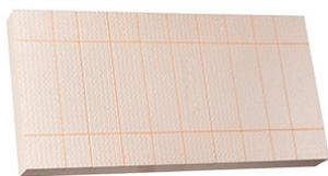
Pannello in polistirene espanso sinterizzato con pellicola esterna trasparente per resistere all'assorbimento d'acqua, stampato a bordo dritto, con superficie esterna ed interna gofrata per un migliore aggrappaggio di collanti/rasati nei sistemi di isolamento a cappotto.
