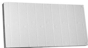
Pannello in polistirene espanso sinterizzato additivato di grafite, Neopor® di BASF, con estradosso in EPS bianco per una migliore riflessione dei raggi solari, stampato a bordo dritto. La superficie esterna ed interna risulta goffrata per un migliore aggrappaggio e presenta pre-tagli sfalsati per garantire un'ottima stabilità dimensionale. Prodotto a marcatura CE e ETICS.
