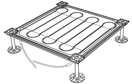
Campi d'applicazione: ideale per la realizzazione di sistemi di riscaldamento a pavimento a secco, su solai con ambiente sottostante riscaldato, nel settore terziario.
