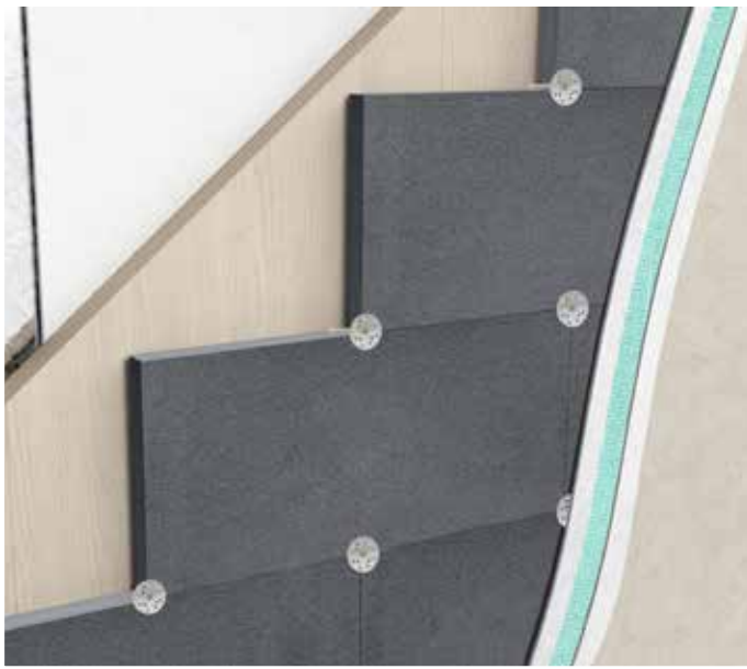
Isolamento a cappotto su parete in legno
