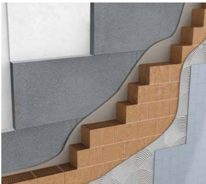
Isolamento in controplaccaggio su parete in laterizio
