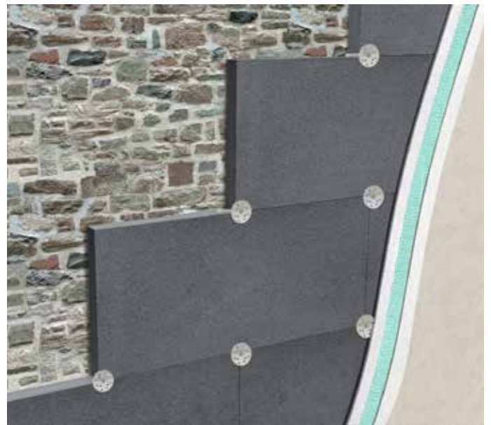
Isolamento a cappotto su parete in pietra
