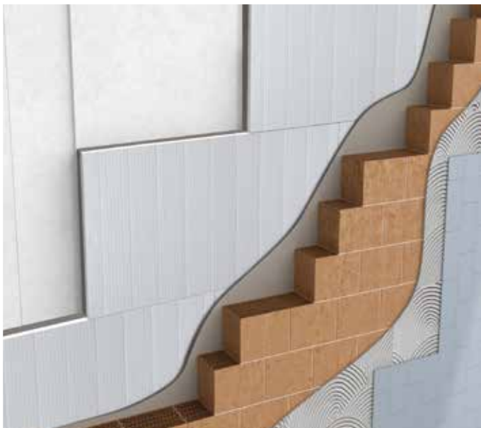
Isolamento in controplaccaggio su parete in laterizio
