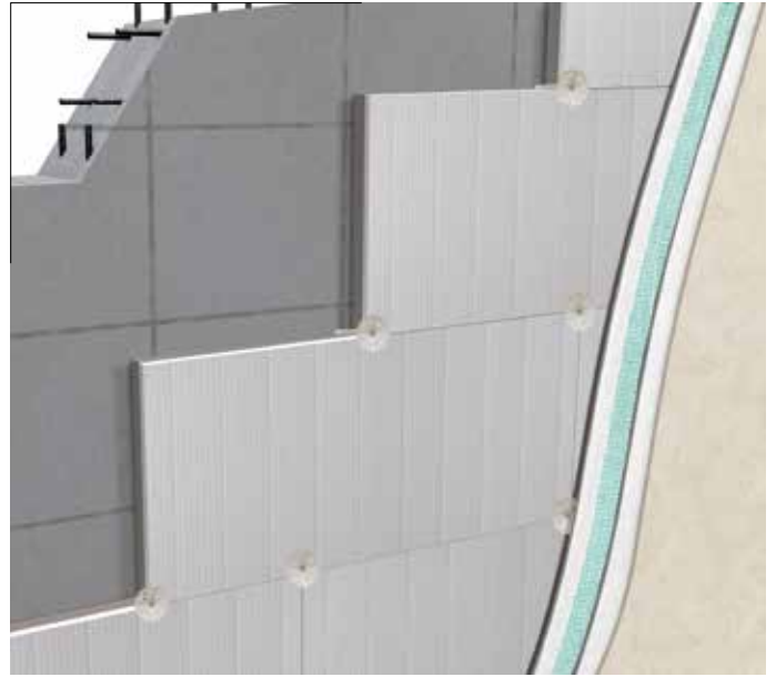
Isolamento a cappotto su parete in calcestruzzo
