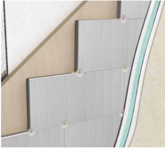
Isolamento a cappotto su parete in legno
