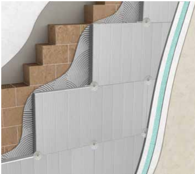
Isolamento a cappotto su parete in laterizio
