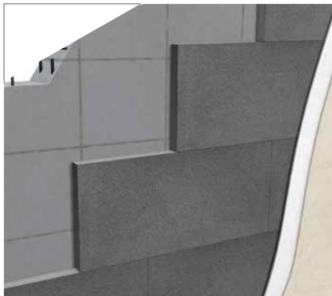
Isolamento a cappotto su parete in calcestruzzo
