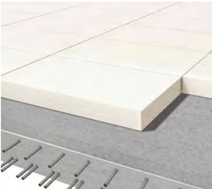
Isolamento per copertura piana con struttura in calcestruzzo
