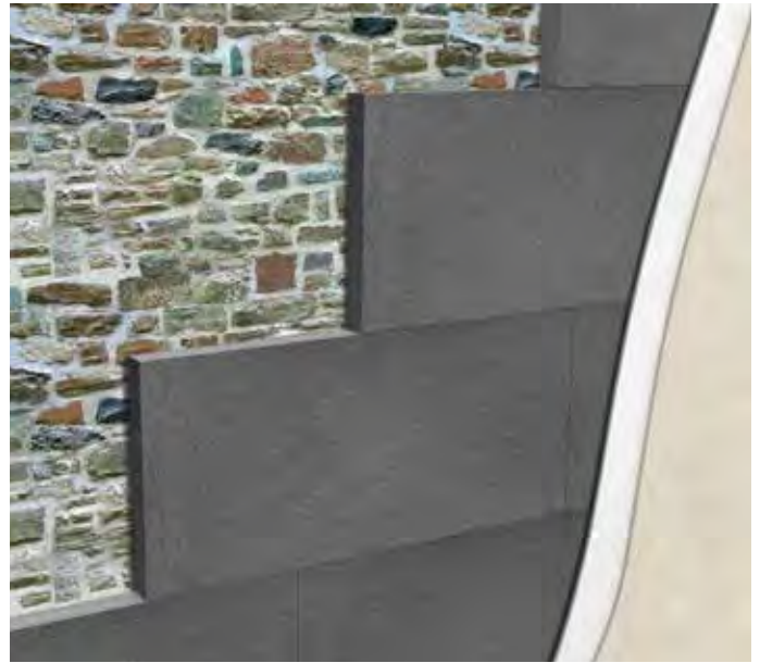
Isolamento a cappotto su parete in pietra
