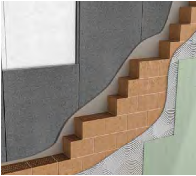
Isolamento in controplaccaggio su parete in laterizio
