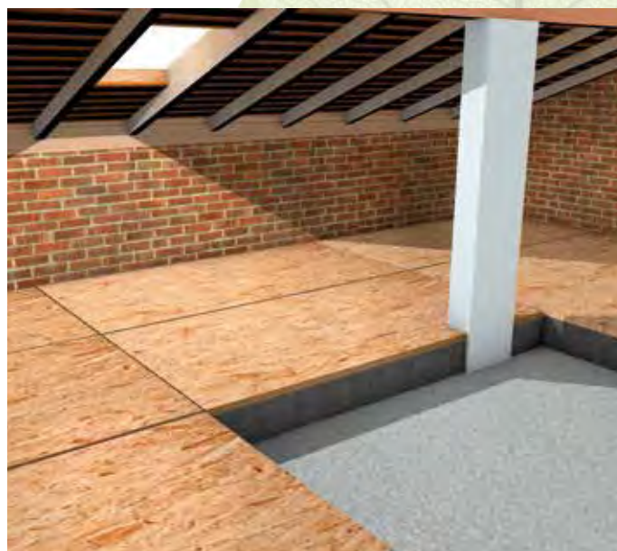
Isolamento del solaio
