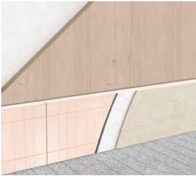
Isolamento a cappotto su parete in legno
