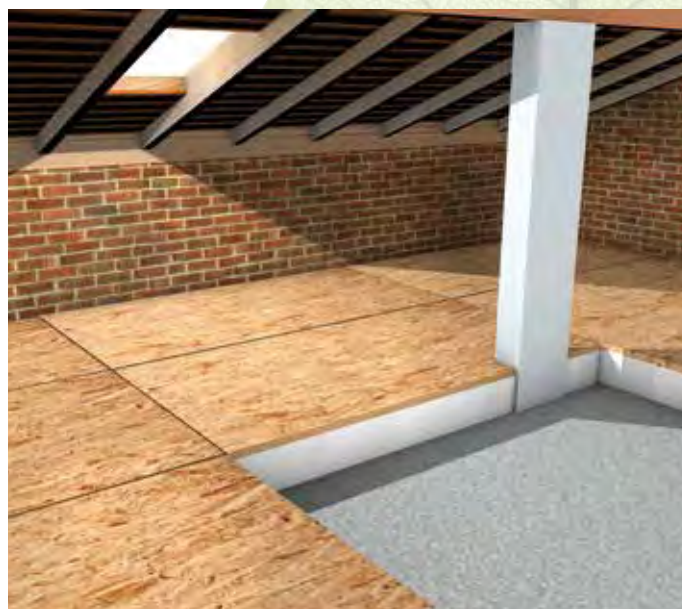
Isolamento del solaio
