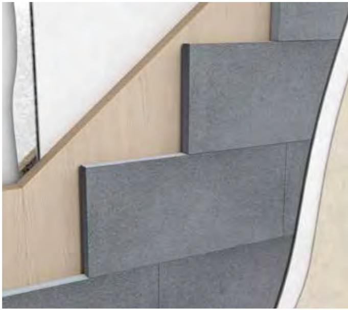
Isolamento a cappotto su parete in legno
