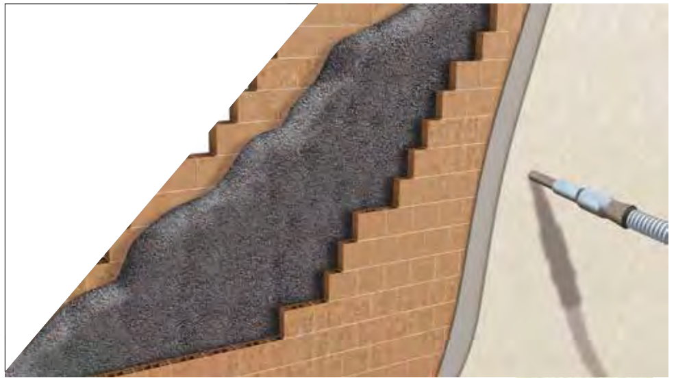
Isolamento in intercapedine tramite insufflaggio
