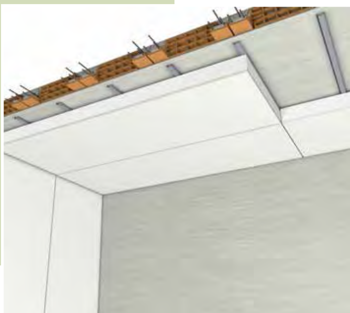
Isolamento interno su soffitto - versione K50, K100, K150
