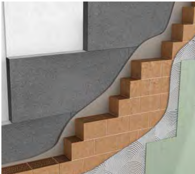
Isolamento in controplaccaggio su parete in laterizio
