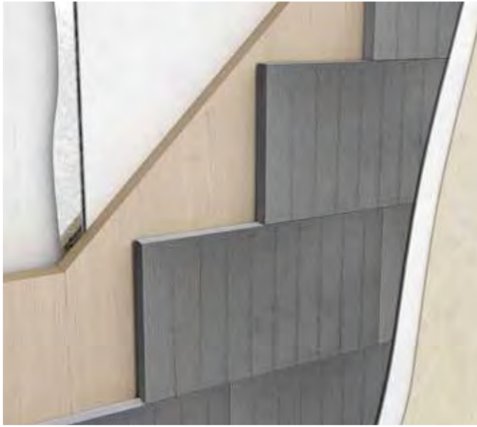
Isolamento a cappotto su parete in legno
