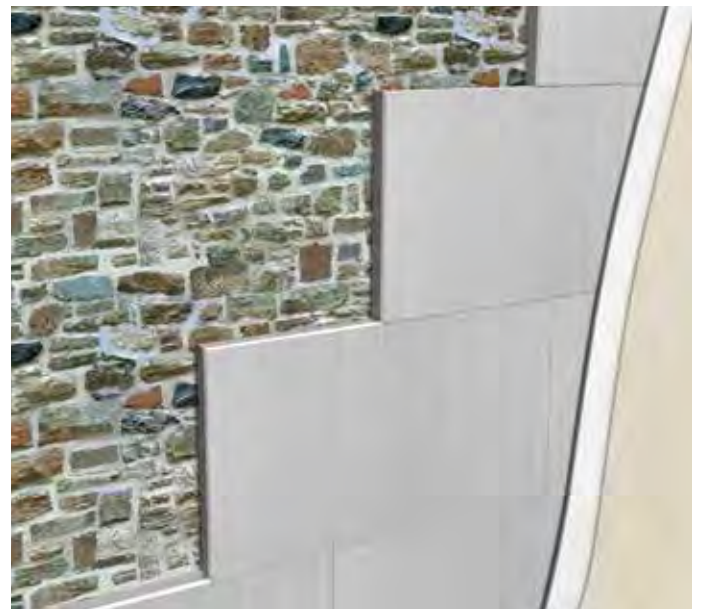
Isolamento a cappotto su parete in pietra
