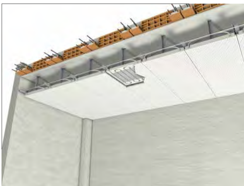
Isolamento interno su controsoffitto con sistemi di riscaldamento e raffrescamento
