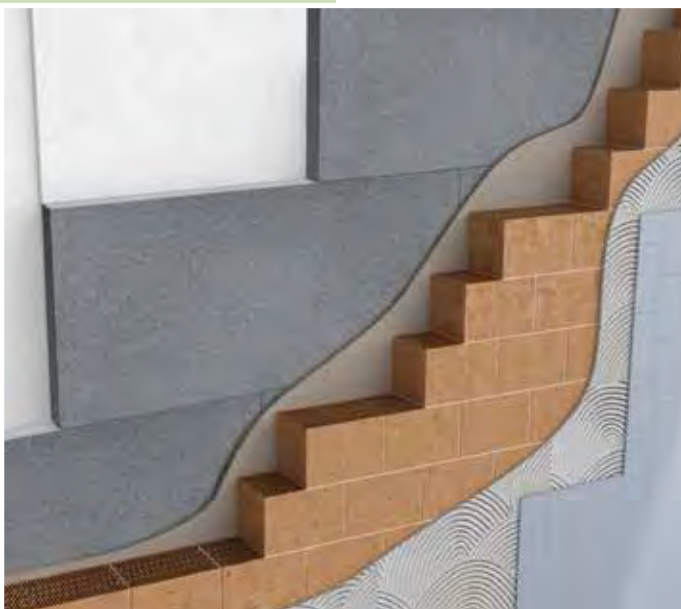
Isolamento in controplaccaggio su parete in laterizio
