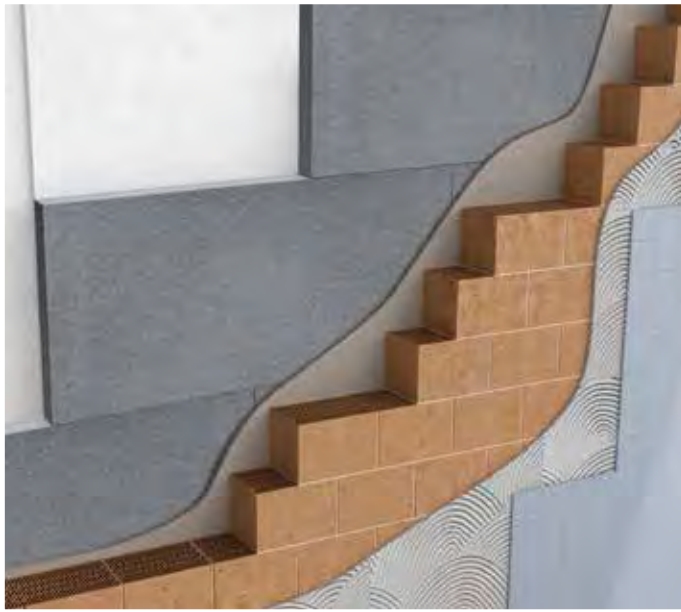
Isolamento in controplaccaggio su parete in laterizio
