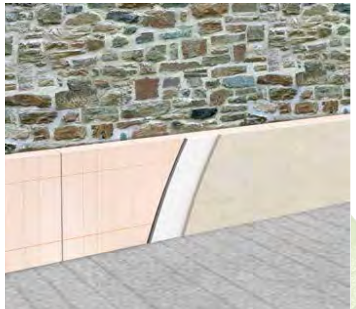
Isolamento a cappotto su parete in pietra
