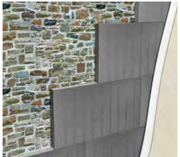
Isolamento a cappotto su parete in pietra
