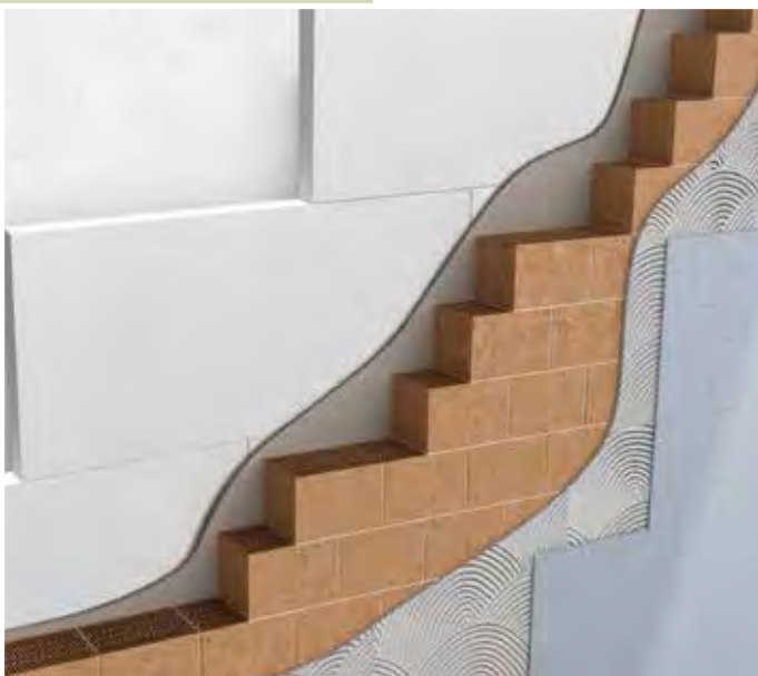
Isolamento in controplaccaggio su parete in laterizio
