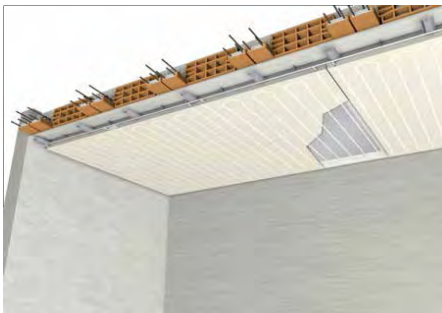
Isolamento interno su soffitto con sistemi di riscaldamento e raffreddamento
