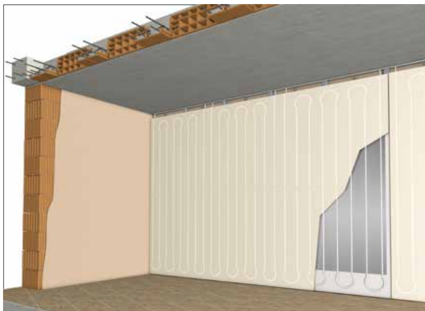
Isolamento in controplaccaggio su parete con sistemi di riscaldamento e raffrescamento
