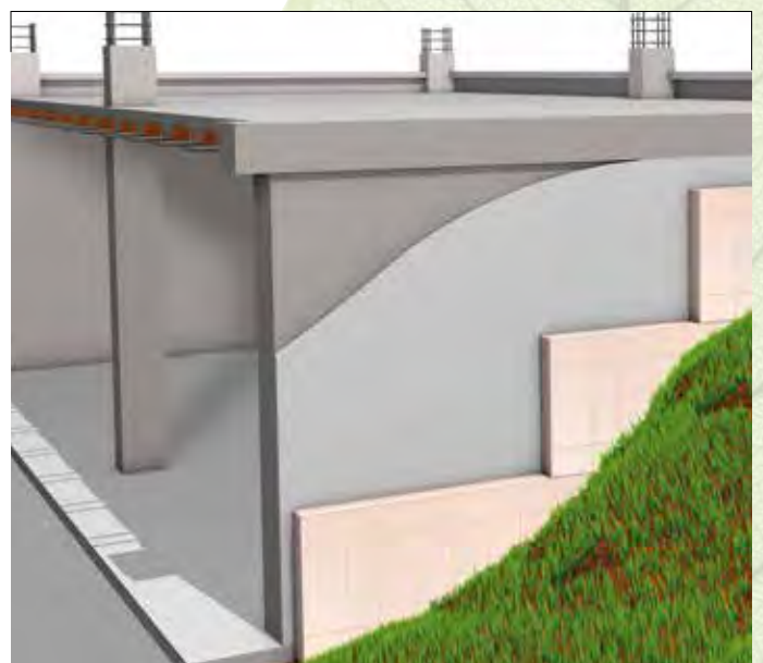
Isolamento del perimetro e del sistema fondazionale
