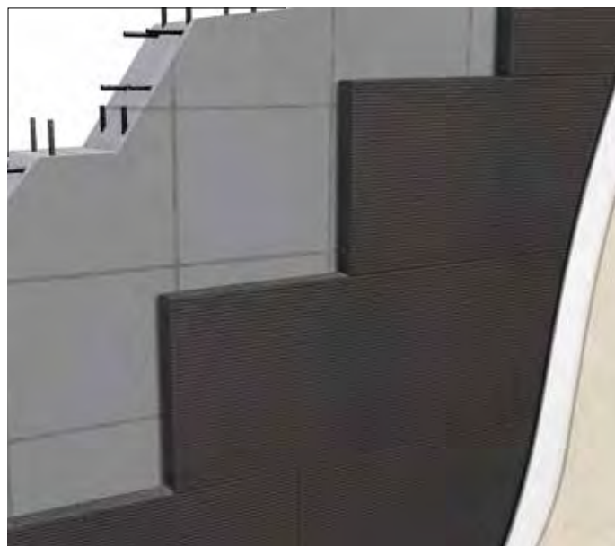
Isolamento a cappotto su parete in calcestruzzo
