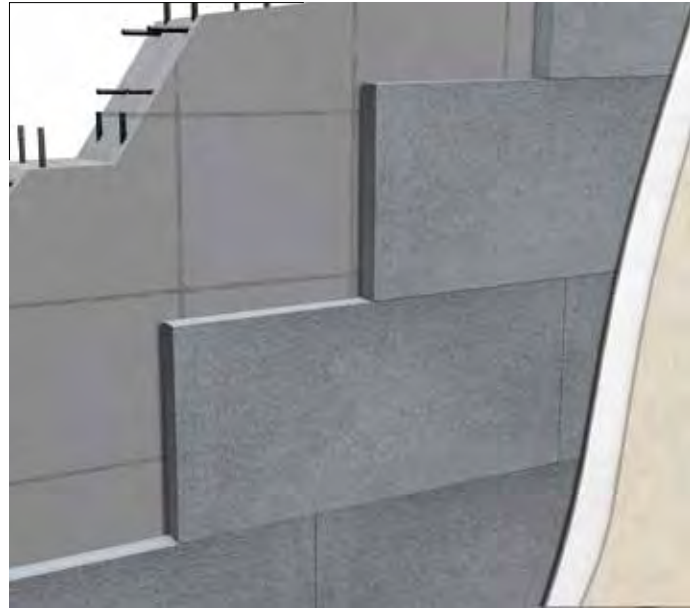
Isolamento a cappotto su parete in calcestruzzo
