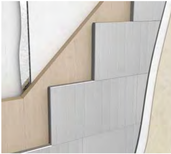
Isolamento a cappotto su parete in legno
