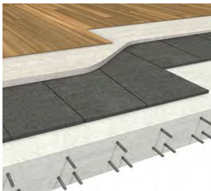
Isolamento del solaio su spazi riscaldati con struttura in calcestruzzo
