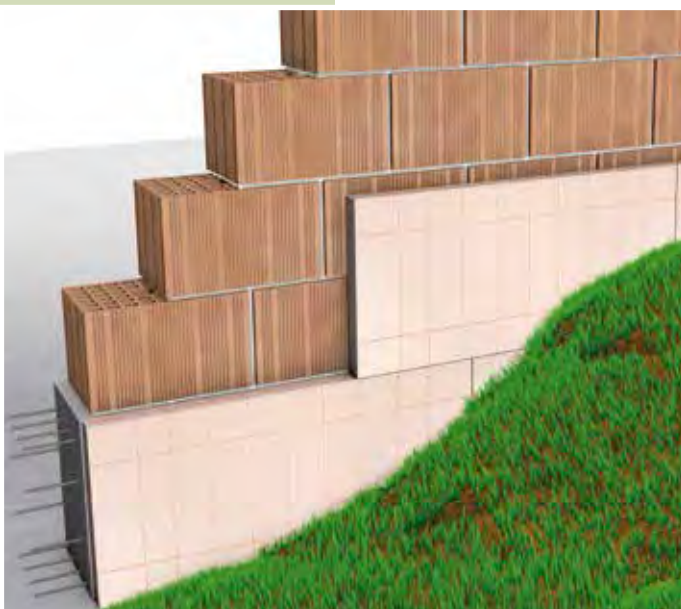
Isolamento del perimetro e dei muri controterra
