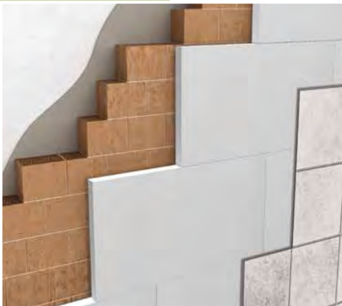
Isolamento in facciata ventilata su parete in laterizio
