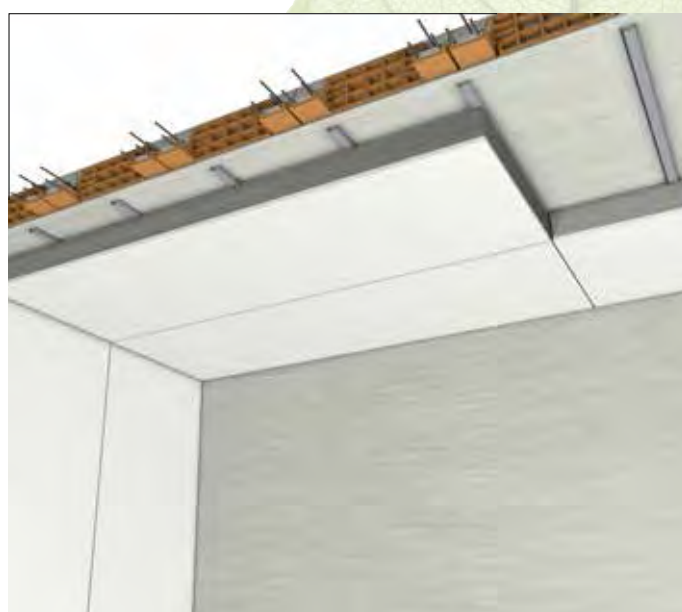
Isolamento interno su soffitto - versione G031
