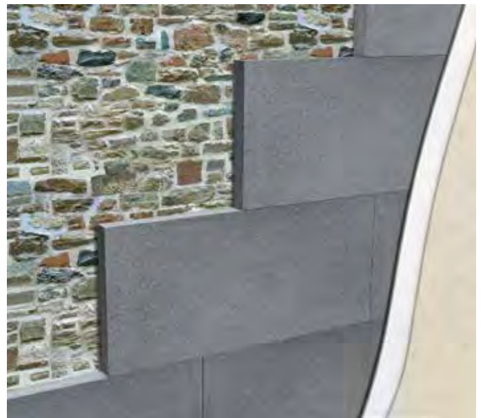
Isolamento a cappotto su parete in pietra
