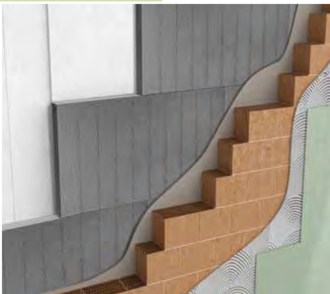
Isolamento in controplaccaggio su parete in laterizio
