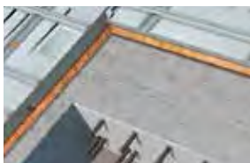
Isolamento per copertura a falda inclinata con struttura in calcestruzzo
