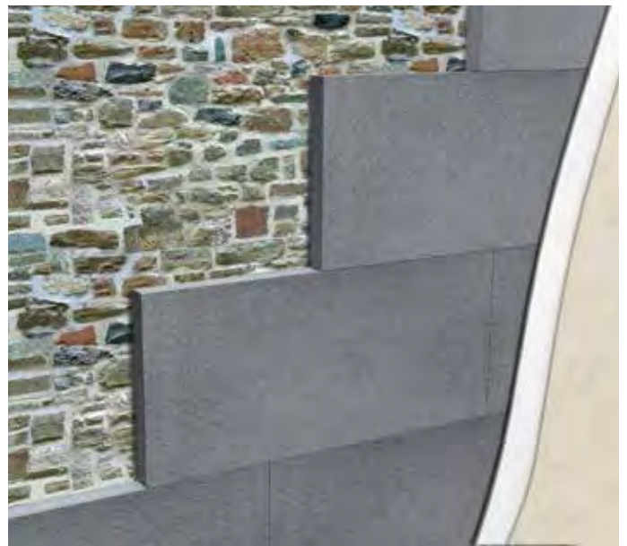
Isolamento a cappotto su parete in pietra
