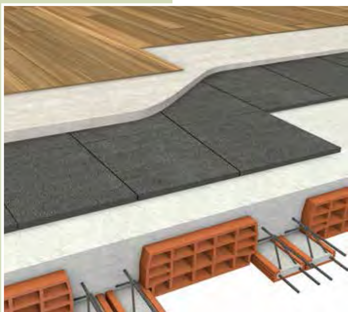
Isolamento del solaio su spazi riscaldati con struttura in latero-cemento
