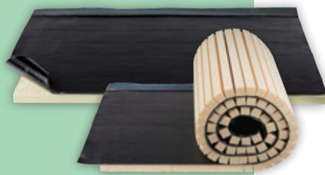
Sistema termoisolante in schiuma poli isocianurato espanso con finitura in cartongesso bitumato, disponibile in formato rotolo (costituito da doghe) o lastra, accoppiato a membrana bitume polimero plastomerica (APP) o elastomerica (SBS), armata in velo vetro (VV) o in tessuto non tessuto di poliestere (PE) di diverso spessore o peso e con finitura liscia o ardesiata (GR).
