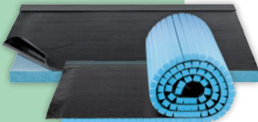
Sistema termoisolante impermeabile in polistirene estruso XPS in formato rotolo (costituito da doghe) o lastra, accoppiato a membrana bitume polimero plastomerica (APP) o elastomerica (SBS), armata in velo vetro (VV) o in tessuto non tessuto di poliestere (PE) di diverso spessore o peso e con finitura liscia o ardesiata (GR).
