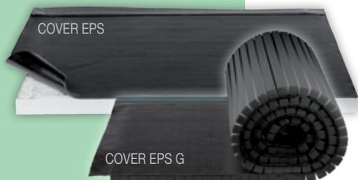
Sistema termoisolante impermeabile in polistirene espanso sinterizzato a vapore in formato lastra o rotolo (costituito da doghe), in EPS bianco o in EPS Neopor® di BASF, accoppiato a membrana bitume polimero plastomerica (APP) o elastomerica (SBS), armata in velo vetro (VV) o in tessuto non tessuto di poliestere (PE) di diverso spessore o peso e con finitura liscia o ardesiata (GR).
