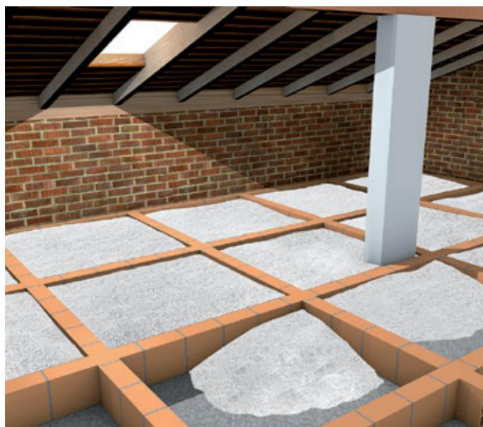
Isolamento del sottotetto mediante insufflaggio
