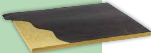
Sistema termoisolante composto da un pannello in lana di roccia, accoppiato a membrana bitume polimero plastomerica (APP) o elastomerica (SBS), armata in velo vetro (VV) o in tessuto non tessuto di poliestere (PE) di diverso spessore o peso e con finitura liscia o ardesiata (GR).
